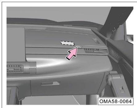
El airbag frontal del pasajero delantero está montado en el interior del tablero de instrumentos (zona sombreada con línea discontinua) con el símbolo "AIRBAG".
