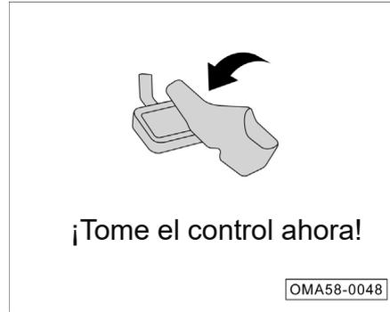
El sistema ICA solo puede utilizar la capacidad de frenado limitada del sistema de frenado de servicio. Cuando el sistema requiere que el conductor intervenga en el frenado, el instrumento combinado muestra la figura anterior y acompaña al sonido del zumbador.
