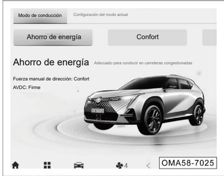
3. Con la alimentación del vehículo en posición "ON", seleccione para cambiar el modo de conducción a través del menú de la aplicación del sistema de audio "Modo de conducción".
