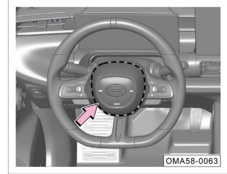
El airbag frontal del conductor está montado en el interior del volante (zona sombreada con línea discontinua) con el símbolo "AIRBAG".
