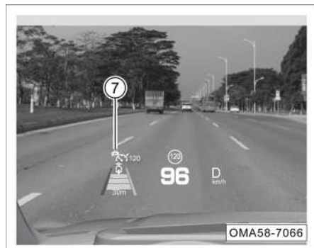
⑦ Sistema de control de crucero adaptativo
