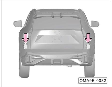
La posición de montaje del sensor de radar en el sistema de monitoreo de zona ciega se muestra en la figura anterior.
