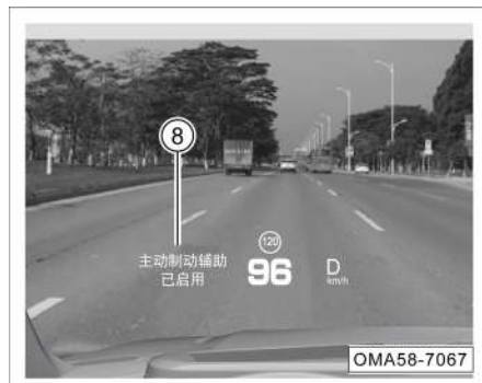
⑧ Sistema de asistencia de frenado activo
