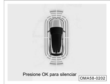
Muestra mensajes de alarma de radar.
