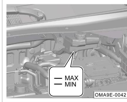
Después de que el motor se haya enfriado, compruebe que el nivel del líquido de frenos esté entre la marca de límite superior "MAX" y la marca de límite inferior "MIN".
