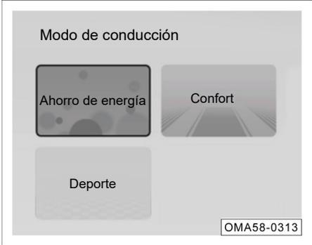
1. Con la alimentación del vehículo en posición "ON", verifique el modo de conducción actual o seleccione el modo de conducción correspondiente a través del botón
