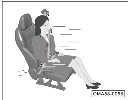
El limitador de fuerza de tipo pretensado del cinturón de seguridad puede reducir la presión del cinturón de seguridad en el pecho del conductor, y mejorar el rendimiento de protección.
