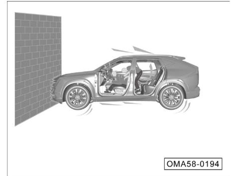
Cuando se produce una colisión del vehículo, los conductores y los pasajeros que no usan el cinturón de seguridad pueden ser arrojados hacia adelante y sufrir lesiones debido a la inercia.
