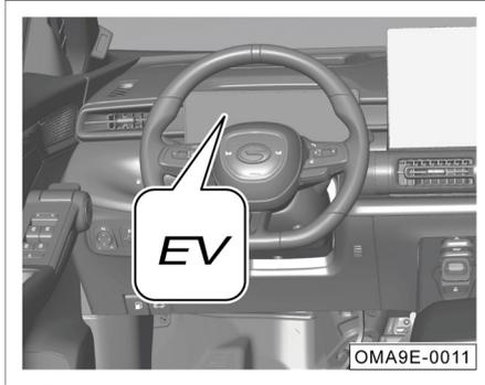
La luz indicadora EV se encenderá cuando el vehículo avance impulsado únicamente por el motor de accionamiento o cuando el motor esté detenido.
