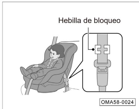
Si la silla de seguridad infantil no tiene el dispositivo para fijar el cinturón de seguridad, monte una hebilla de bloqueo en el cinturón de seguridad.
