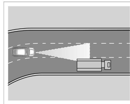
3. Salir de la curva. Al salir de una curva larga, debido a que el sistema calculará previamente el carril de conducción, el sensor de radar puede reaccionar al vehículo en el carril adyacente y frenar el vehículo. Este proceso de frenado se puede interrumpir presionando el pedal del acelerador.
