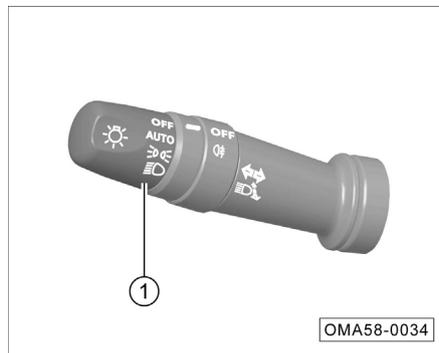
Cuando la alimentación del vehículo está en la posición "ON", al girar el interruptor de la luz ① se puede controlar para encender o apagar AUTO (luz automática), DRL (luz de posición), DRL (luz de cruce).
