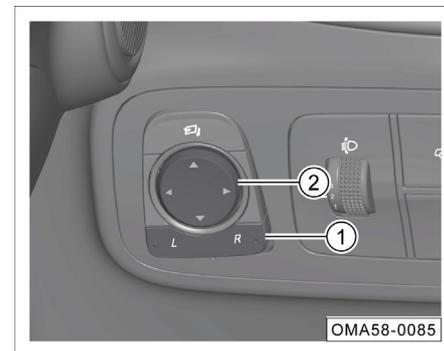
El botón de ajuste del espejo retrovisor exterior está ubicado en la parte inferior izquierda del tablero de instrumentos.
