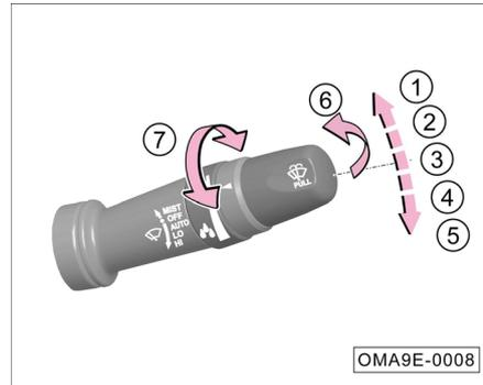
Cuando la alimentación del vehículo está en la posición "ON", el interruptor combinado del limpiaparabrisas se puede operar:
