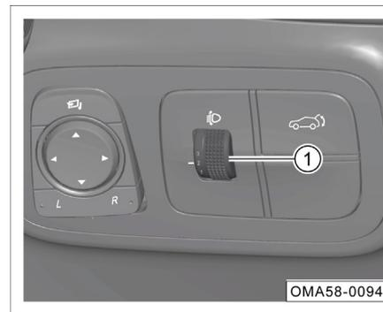
Gire la perilla ① para ajustar manualmente el rango de iluminación de los faros (luz de cruce), y las posiciones de ajuste son "0, 1, 2, 3". La altura de la luz disminuirá a medida que aumente el valor de ajuste.
