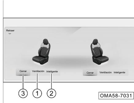
Cambie la alimentación del vehículo a la posición "ON", haga clic en el icono de ventilación del asiento en la parte inferior de la interfaz principal del sistema de audio y aparecerá la interfaz de configuración de ventilación del asiento.
