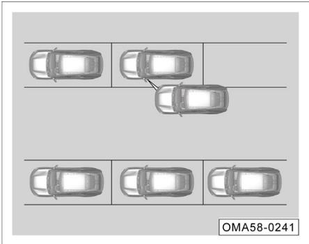
La función de advertencia de apertura de puerta detecta el carril adyacente cuando el vehículo se detiene a través del radar de la zona ciega instalada en la parte posterior del vehículo. Cuando se detecta que un vehículo/bicicleta/peatón se acerca rápidamente y la apertura de puerta del vehículo está en peligro, el sistema avisará al conductor a través de la señal visual del espejo retrovisor exterior y el sonido de la alarma.
