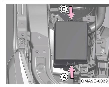
1. Abra el capó, busque la caja de fusibles del arnés en la rueda derecha, presione la hebilla de fijación en el sentido de -flecha A- y -flecha B- para desbloquearla por completo y luego retire la tapa.
