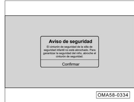
Durante el uso normal de la silla Bluetooth, si se afloja el cinturón de seguridad, la interfaz del sistema de audio mostrará un mensaje de alarma "El cinturón de seguridad de la silla de seguridad infantil no está abrochado. Para garantizar la seguridad del niño, abrache el cinturón de seguridad." y siempre existirá. Después de abrocharse el cinturón de seguridad, la ventanilla emergente de alarma desaparece.
