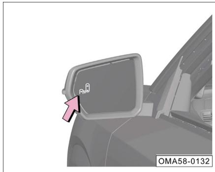
El sistema de monitoreo de punto ciego avisa al conductor mediante la luz indicadora
