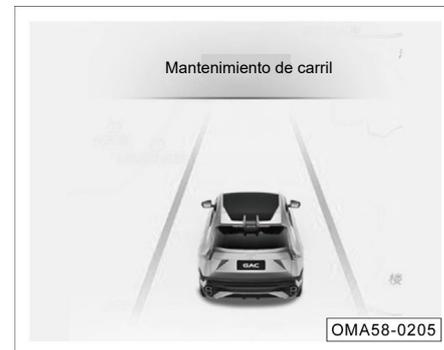
Cuando la alimentación de vehículo está en la posición "ON", gire hacia arriba/abajo el botón "OK" situado en el lado izquierdo del volante para ver el estado actual de la conducción asistida.
