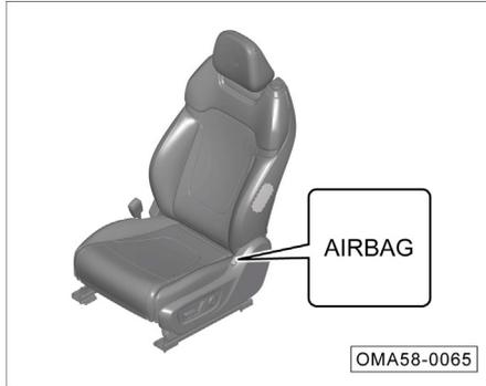
El airbag lateral de la fila delantera está montado en el interior de la respaldo del asiento del conductor y asiento del pasajero, que está en el lado hacia la puerta (parte sombreado por línea de puntos), y "AIRBAG" es el símbolo del airbag.
