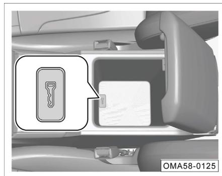
Si la batería de la llave de control a distancia inteligente está baja y la pantalla del instrumento combinado muestra "no se detectó ninguna llave", puede colocar la llave de control a distancia inteligente horizontalmente en la marca de llave en la parte inferior de la caja de reposabrazos central delantero, luego presione el interruptor de arranque para cambiar a la posición "ACC" u "ON",
