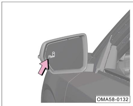
El sistema de advertencia de apertura de puerta le recuerda al conductor a través de la luz indicadora
