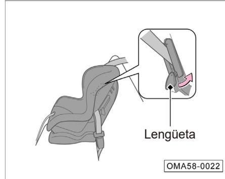
5. Coloque correctamente el cinturón de seguridad y empuje la lengüeta hacia arriba. Asegúrese de que el cinturón de seguridad no esté torcido. Al empujar la lengüeta hacia arriba, tire la parte superior del cinturón de seguridad del hombro hacia arriba, para que el cinturón de seguridad no esté suelto.
