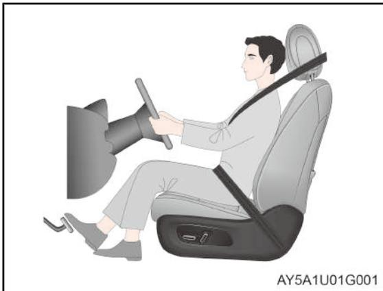
1. Ajuste la posición del asiento de modo que los pedales puedan accionarse con facilidad y los codos puedan flexionarse ligeramente al sujetar el volante.
