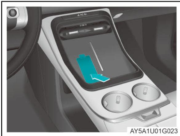
Coloque un teléfono móvil que soporta carga inalámbrica en el área de carga inalámbrica. Para garantizar una buena experiencia de carga inalámbrica, se recomienda colocar el teléfono móvil lo más cerca posible de la salida de aire en la parte trasera del área de carga y alinear la bobina de carga del teléfono móvil con el área de carga como se muestra en la imagen.
