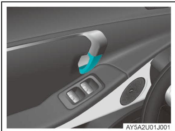
Cuando la puerta esté bloqueada, tire de la manija interior de la puerta de la fila delantera hacia el interior del automóvil para desbloquearla.
