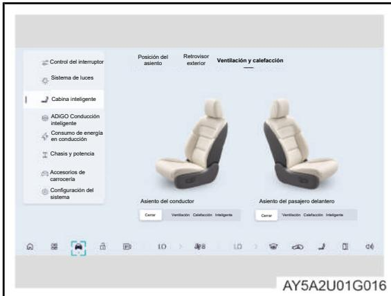
Haga clic en la pantalla de control central para ingresar a la interfaz de configuración de ventilación/calefacción del asiento y configure la ventilación/calefacción del asiento según sea necesario.
