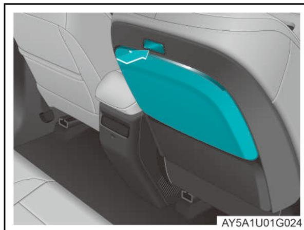
Presione el botón de desbloqueo y la mesita saltará por una distancia corta. Luego tire lentamente hacia arriba hasta que la mesita quede plana.
