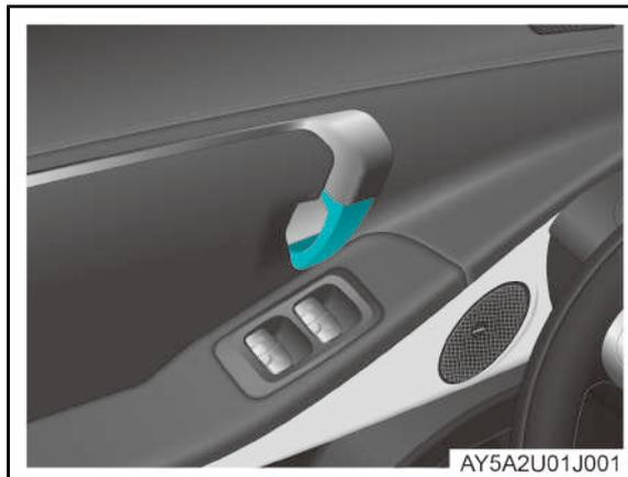
Después de desbloquear la puerta, tire de la manija interior de la puerta de la fila delantera hacia el interior del automóvil para abrirla.
