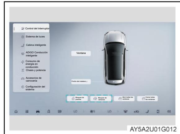
Antes de conducir, bloquee las puertas a través de la pantalla de control central.
