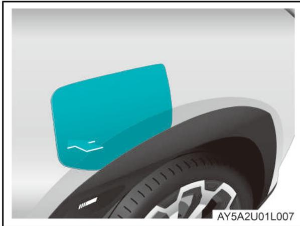
2. Abra la cubierta antipolvo del puerto de carga de CA.
