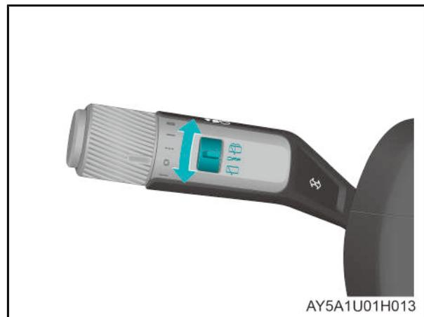
Mueva el interruptor de control del limpiaparabrisas trasero hacia arriba o hacia abajo desde la posición APAGADO para seleccionar el modo del limpiaparabrisas trasero. Los controles específicos son los siguientes:
