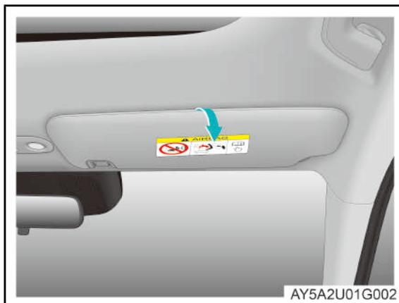
La visera se encuentra por encima del conductor principal y del copiloto. Voltear la visera protege de la luz deslumbrante que viene del frente.
