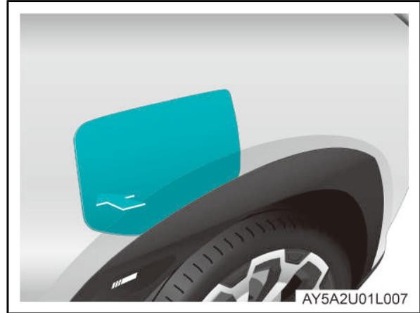
1. Después de desbloquear el vehículo, presione el borde trasero de la cubierta del puerto de carga para abrirla.
