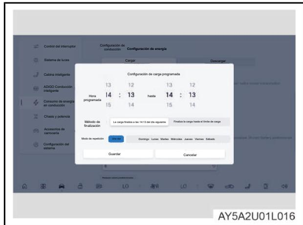
3. En la interfaz de configuración del tiempo de la carga programada, configure el tiempo de la carga programada, el método de finalización y las fechas de repetición.
