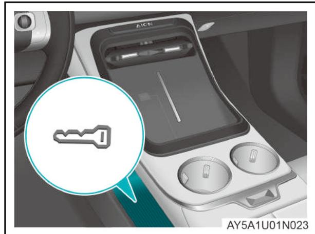
Cuando la batería de la llave inteligente esté agotada o sea insuficiente, después de ingresar al vehículo, coloque la llave inteligente en la marcación de llave dentro del apoyabrazos central delantero y presione el pedal del freno al mismo tiempo para encender el vehículo en caso de emergencia, y mueva la palanca de cambios lo antes posible
