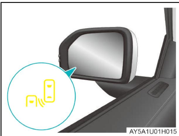
Mientras conduce (la velocidad del vehículo es superior a 15 km/h), si otros vehículos entran en la zona ciega desde atrás o desde el costado, o un automóvil se acerca rápidamente desde el carril trasero adyacente, o un vehículo ingresa a
