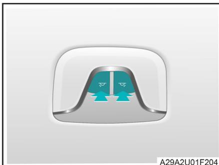
Pulse el interruptor de la luz de lectura delantera para encender o apagar la luz de lectura delantera del lado correspondiente.
