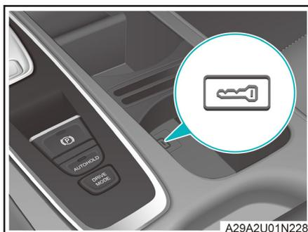
1. Coloque la llave inteligente horizontalmente en la marca de llave situada en la parte inferior del portavasos delantero.
