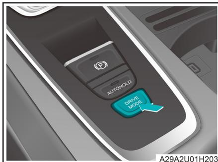
Después de conectar la alimentación de todo el vehículo, se cambia al modo de conducción normal mediante el botón de cambio de modo de conducción del salpicadero o la consola central.
