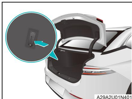
2. Desbloquee el conector de carga tirando del cable de desbloqueo manual del mismo situado en el interior de la placa protectora izquierda del maletero.
