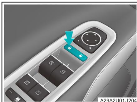
Cuando las puertas estén bloqueadas, pulse el extremo de desbloqueo del interruptor de cierre centralizado del interior del vehículo para desbloquear todas las puertas.
