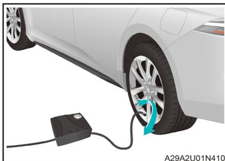
2. Enrosque el conector de la bomba de inflado en la válvula del neumático.
