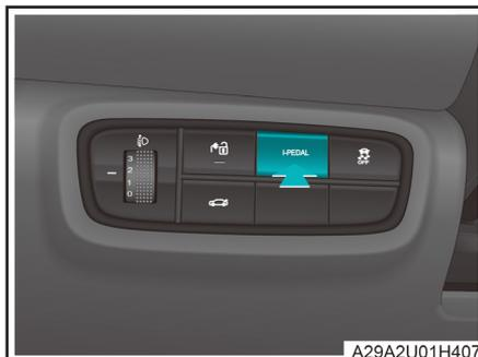
Tras conectar la alimentación de todo el vehículo, se pasa al modo de conducción especial mediante el botón I-PEDAL situado en el lado izquierdo del salpicadero. Pulse brevemente el botón I-PEDAL para cambiar el modo de conducción al modo I-PEDAL; pulse prolongadamente el botón I-PEDAL para cambiar el modo de conducción al modo ECO+.
