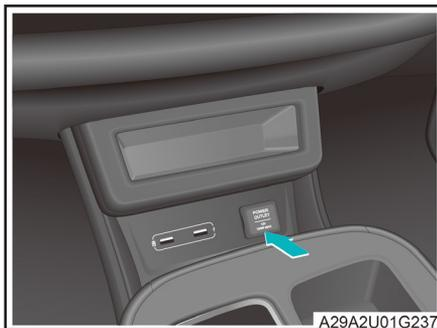
Cuando el estado de encendido del vehículo esté en "ACC" u "ON", levante la cubierta protectora del conector de alimentación de 12 V mientras conecta un dispositivo eléctrico para utilizar la alimentación de 12V.
