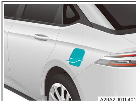
2. Desbloquee el vehículo y abra la tapa del puerto de carga de CC presionando en el borde posterior de la tapa del puerto de carga situada en el lado izquierdo del vehículo.
