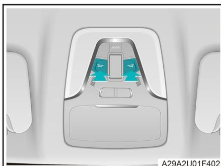
Pulse el interruptor de la luz de lectura trasera para encender o apagar la luz de lectura trasera del lado correspondiente.
