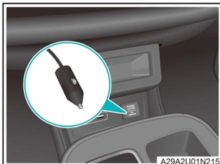
4. Conecte el enchufe de la bomba de inflado a la toma de corriente del vehículo.
