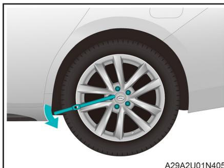
1. Utilice una llave de tornillos de rueda para girar el tornillo de rueda en el sentido contrario a las agujas del reloj y aflojarlo de 1 a 2 vueltas.
