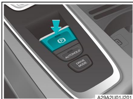
Cuando la alimentación de todo el vehículo está en estado "ON" y la posición no está en "P", pise el pedal del freno y pulse el botón de freno de estacionamiento electrónico EPB, la luz indicadora del botón y la del instrumento (P) se apagarán, y el freno de estacionamiento se liberará.
