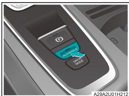
Presione el interruptor de asistente de aparcamiento para activar o desactivarlo cuando se cumpla la condición de la activación de asistente de aparcamiento. Cuando la función
