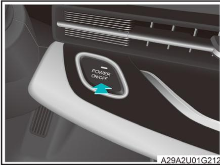
Cuando se accede al vehículo con la llave inteligente y se pulsa de forma continuada el botón de arranque con una sola pulsación sin pisar el pedal de freno, el estado de encendido puede cambiar entre "OFF" → "ACC" → "ON" → "OFF".
