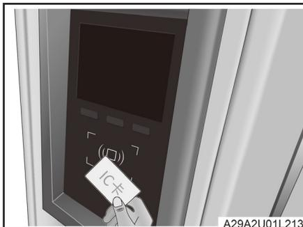
5. Realice los ajustes pertinentes para el poste de carga (por ejemplo, escaneando el código QR o pasando la tarjeta) e inicie el poste de carga.
