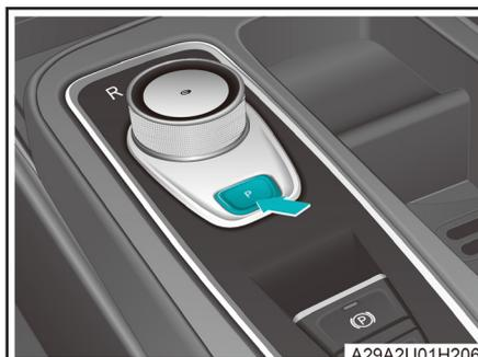
Después de que el vehículo se haya detenido por completo, pulse el botón "P" para cambiar la marcha a "P", y el freno de estacionamiento
