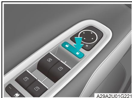
Cuando las puertas estén cerradas, pulse el extremo de bloqueo del interruptor de cierre centralizado en el interior del vehículo y todas las puertas se bloquearán.
