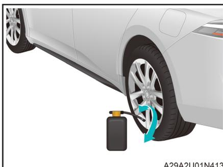
2. Agite el sellador de neumáticos y enrosque el conector del sellador en la válvula del neumático.
